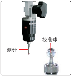
探针 (选配), 包含Ø1mm和 Ø2 mm测针, Ø20mm校准球, 测量精度5μm
